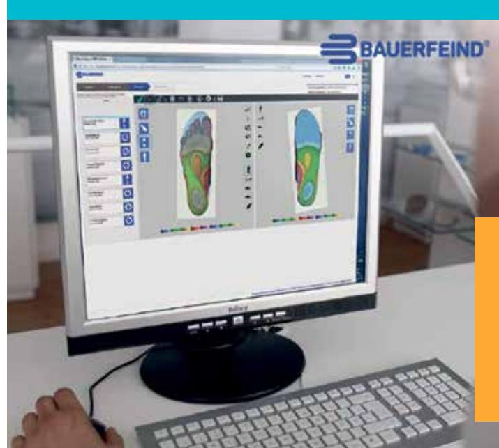
Kruna Bauerfeindove medicinske opreme svakako je **Bodytronic® MediLogic** uređaj za digitalno skeniranje stopala. Sustav funkcioniра priključivanjem radiotransmitera nakon čega se mjeri distribucija pritiska na stopalo tijekom hoda. Senzori detektiraju pokret i informacije šalju na software. Rezultati mjeranja i asimetrija mogu biti u izobaričnom, senzornom ili 3D prikazu.
